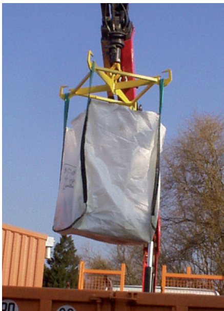
X-BAG – palonnier pour Big-Bag X-BAG – Big-Bag lifting beam X-BAG : big-bag Traverse
