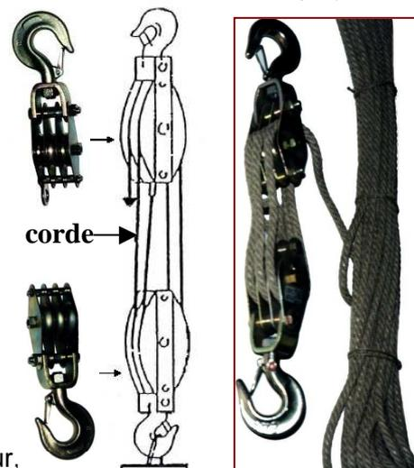
La moufle équipée du ringot doit être placée sur le point d'accrochage, et l'autre moufle reprend la charge.
