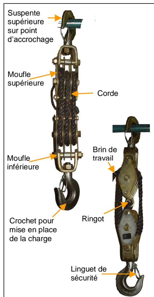
Le point d'accrochage du moufle supérieur doit avoir une résistance mécanique au moins équivalente à la charge à la suspente supérieure du mouflage utilisé :
